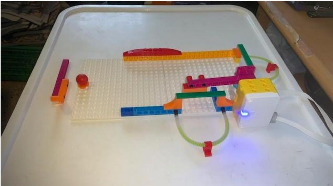
Como el movimiento mínimo de un motor es de un cuarto de vuelta este tiene que estar posicionado tapando la partería inferior, en el caso de programación por palabras este esta situado a mitad entre las dos porterías.
