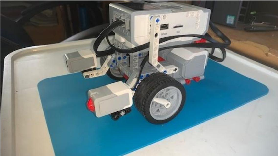
En este capítulo vamos a ejecutar dos tareas simultáneamente una para el sensor de color y otra para el sensor táctil.
