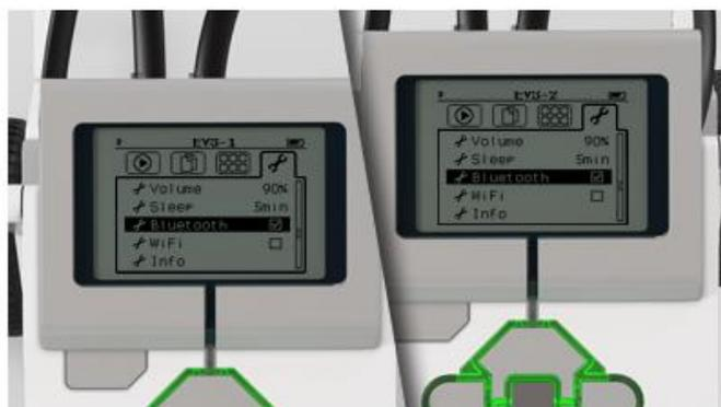
Asegúrate de que Bluetooth esté activado y visible en ambos Bloques EV3.
