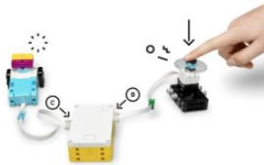
Conecta un Sensor de fuerza en el puerto B y un motor al puerto C.
