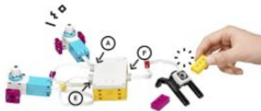
Conecta un Sensor de color al puerto F y dos motores a los puertos A y E.
