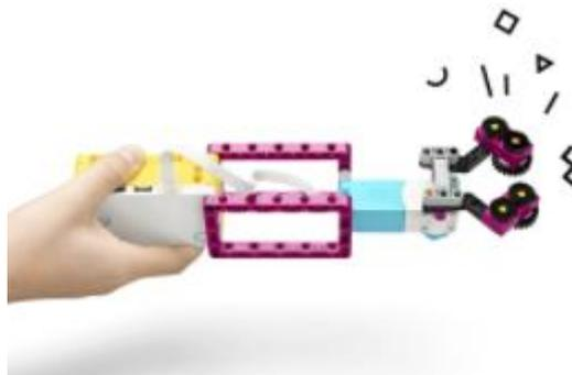
Vais a ejecutar el programa presionando el botón izquierdo del Hub para comprobar que la mano robótica se cierra.
