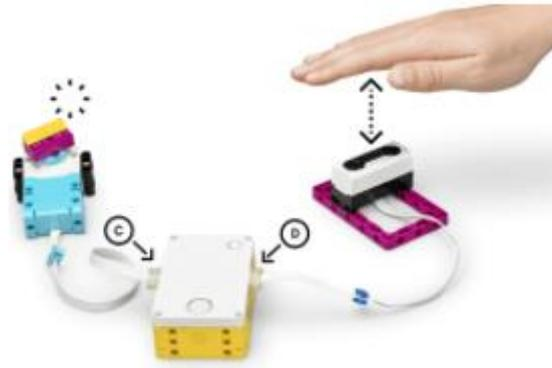
Conecta un Sensor de distancia al puerto D y un motor al puerto C.
