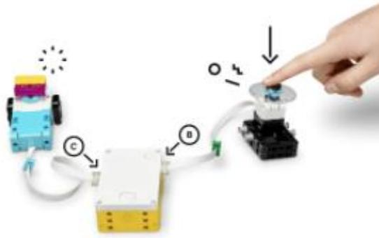
Con un Sensor de fuerza conectado al puerto B y un motor en el puerto C, vamos a descubrir maneras de cambiar el flujo de ejecución del programa.
