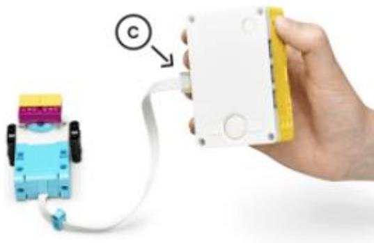
Ahora, vamos a conectar un motor y encenderlo. Conecta un motor a uno de los puertos con letra (por ejemplo, puerto C).
