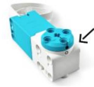
Vamos a llevar el motor a la posición de 0 grados desde cualquier posición de la que te encuentres actualmente. Su posición viene indicada por el marcador del motor.
